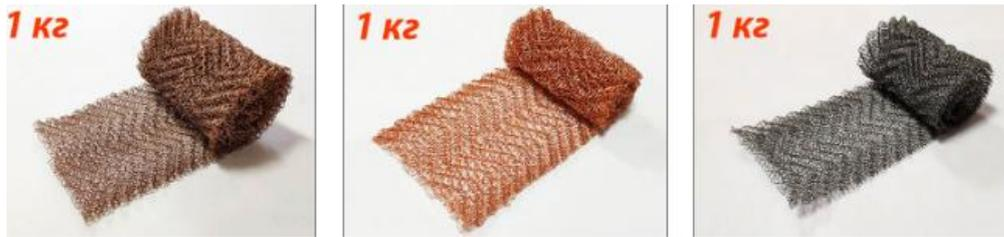
**Регулярная проволочная насадка Панченкова** используется в качестве комплектующего для колонного, сепарирующего, абсорбционного оборудования. Представляет собой сетчатую гофрированную ленту из тонкой металлической проволоки. В промышленных агрегатах выполняет роль массо- и теплообменника. За счет большой эффективной площади поверхности способна отделять большое количество жидкости и твердых примесей из потока газообразного продукта.
