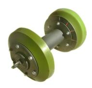
**Поршни полиуретановые манжетные ППМ** являются разновидностью очистных поршней для внутренней поверхности трубопровода. Поршень ППМ состоит из металлического корпуса и закрепленных на нем полиуретановых манжет, благодаря которым увеличивается площадь соприкосновения поршня с внутренней полостью трубопровода.
