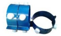
Опорно-направляющие кольца ОНК используются при возведении переходов подземных стальных трубопроводов, прокладываемых в защитном кожухе. При проведении трубопроводов, укладке кабелей, коммуникации заключают в защитный кожух (футляр) — трубу большего размера. Предохранить их от коррозии, электрически изолировать, исключить повреждение при протаскивании, сдавливании трубопровода, помогает опорно-направляющее кольцо (ОНК). Применяются для стальных труб.
