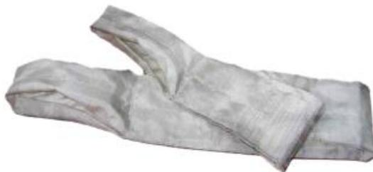
**Мягкие силовые пояса МСП (соединительные)** предназначены для крепления бетонных и чугунных утяжелителей УБО на трубопроводе и защите поверхности трубопровода от контакта с жесткими элементами утяжелителей. Применяются при балластировке трубопровода в различных грунтовых условиях, в том числе на болотах.
