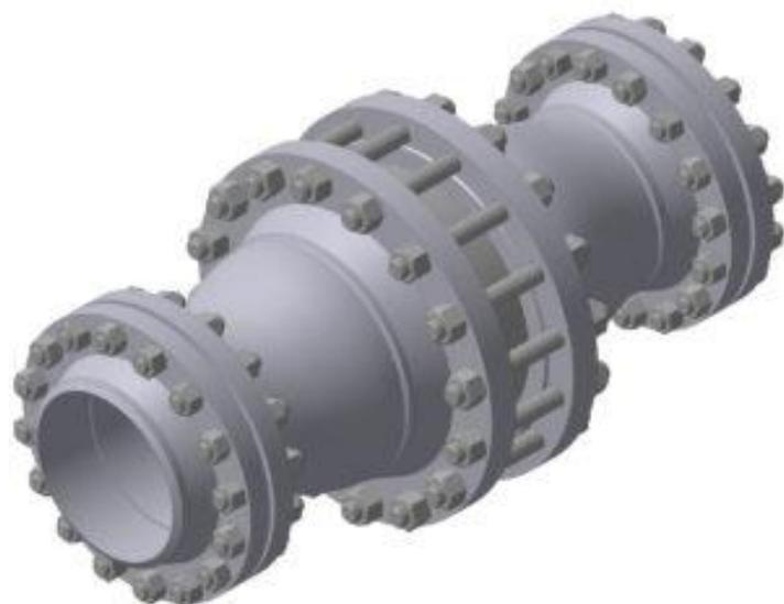
Огнепреградители детонационнотойкие коммуникационные обладают мощным корпусом и усиленным пламегасящим элементом. За счет этого изделие успешно противостоит ударной волне в случае детонации продукта. В нем также конструктивно предусмотрено устройство, демпфирующее удар. Основной элемент – пламегаситель кассетного типа из теплоемких огнестойких сплавов.
