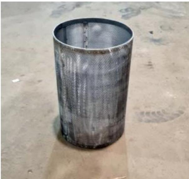
Фильтрующая сетка для фильтра имеет регулярные ячейки, через которые свободно протекает транспортируемый продукт. При этом она является препятствием, на котором задерживаются твердые частицы с размерами не меньше указанных в документации к фильтру. Замена требуется при механическом повреждении или износе.
