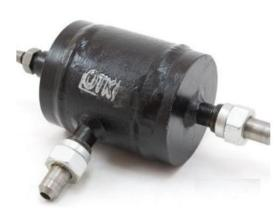
Сосуды уравнительные СУ предназначены для поддержания постоянного уровня жидкости в соединительном трубопроводе относительно измеряемого переменного уровня в резервуаре, таким образом исключая воздействие на результаты измерительных процедур высоты столба среды в импульсной линии.
