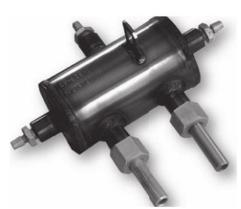
Сосуды конденсационные уравнительные разделительные СКУР — универсальный тип сосудов, выполняющий все передаточные функции сосудов для полного сохранения безопасности измерительного прибора: предохранение полости измерительного прибора от агрессивной измеряемой рабочей среды; поддержание постоянного уровня конденсата на входе в измерительную систему; компенсация избыточного давления газа в контролируемых трубопроводах и установках.
