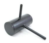
Сосуды конденсационные СК применяют в процессе измерения расхода водяного пара. За счет метода переменного перепада давления, этот элемент обеспечивает равенство и поддержание на постоянном уровне конденсата в системе, которая передает перепад давления от диафрагмы к дифманометрам — преобразователям дифференциального давления. Сосуды конденсационные поддерживают уровень конденсата в
