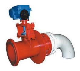
**Приемо-раздаточные устройства ПРУ** используются для предотвращения потерь нефти и нефтепродуктов при заполнении или опорожнении хранилищ на нефтебазах. ПРУ располагаются в нижней части резервуара, крепятся к патрубку ППР. Использование ПРУ позволяет увеличить полезный объем емкости за счет слива продукта до минимально возможного уровня, то есть повысить эффективность эксплуатации хранилища и облегчить проведение рабочих операций.
