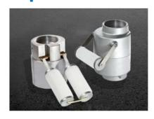
Ограничители налива (клапаны отсечные) регулируют степень заполнения резервуара на АЗС. Так как слив нефтепродуктов является пожароопасной процедурой, использование такого механизма предотвращает переполнение емкости и возгорание топлива. Устанавливаются на вертикальном участке трубопровода
