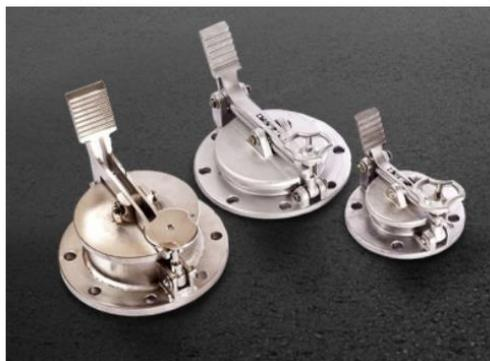
**Люки замерные ЛЗ** устанавливают на стальных цилиндрических резервуарах с нефтью и нефтепродуктами с целью обеспечить быстрый доступ к содержимому, чтобы выполнить отбор проб или определить степень наполненности резервуара. Прокладка выполнена из резины, которая безопасно контактирует с маслами, нефтепродуктами и прочими техническими жидкостями.
