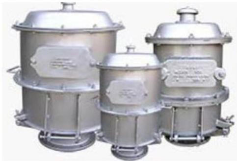
**Клапан непримерзающий дыхательный мембранный НДКМ** – герметизирующее устройство для резервуаров с жидкими нефтепродуктами. Позволяет существенно сократить потери от испарения и повысить экологическую безопасность объекта. Представленные в этом разделе дыхательные клапаны НДКМ – со встроенными огнепреградителями, которые предотвращают риск пожаров и детонации. Они различаются между собой рабочими давлениями, присоединительными диаметрами и другими параметрами.
