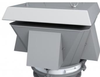
**Клапан дыхательный совмещенный КДС-1500** – герметизирующий узел для резервуаров, содержащих легкогорючие жидкости (нефть и продукты ее переработки). Это устройство со встроенным огнепреградителем, существенно повышающим степень противопожарной защиты объекта. Совмещает в себе две функции – клапана давления и вакуумного клапана. Обеспечивает целостность конструкции емкости, повышает безопасность сливных и наливных операций, защищает от взрыва газовой смеси в незаполненном жидкостью объеме.
