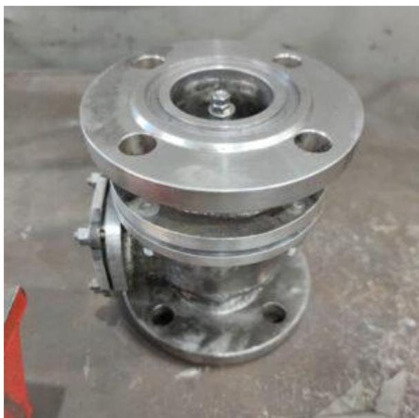
Клапан дыхательный закрытого типа КДЗТ используется для эффективного поддержания заданного давления газовой среды в резервуаре с нефтепродуктами, предотвращая аварийные ситуации. При охлаждении-нагревании, а также при закачке-выкачке содержимого давление газовой смеси может меняться в широких
