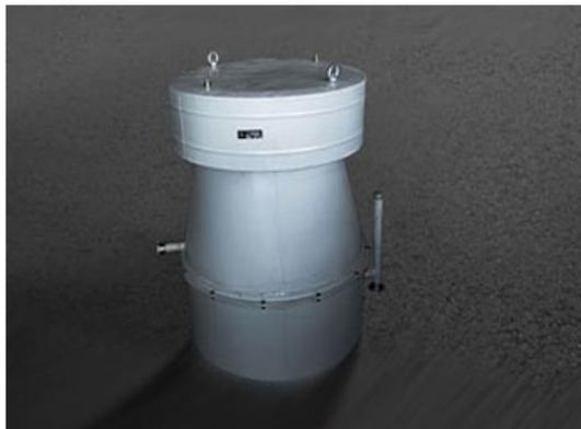
Клапан предохранительный гидравлический КПГ служит защитным устройством для резервуаров с нефтью и продуктами ее переработки на тот случай, если дыхательный клапан надлежащим образом не сработал. Возвращает давление газовой смеси внутри емкости к норме, тем самым предотвращая нарушение ее целостности. Это многофункциональный узел со встроенным огнепреградителем, который дает дополнительную защиту от воспламенения и детонации горючих паров.
