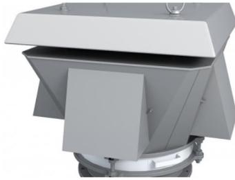
**Клапан дыхательный совмещенный КДС-1500** – герметизирующий узел для резервуаров, содержащих легкогорючие жидкости (нефть и продукты ее переработки). Это устройство со встроенным огнепредгадителем, существенно повышающим степень противопожарной защиты объекта. Совмещает в себе две функции – клапана давления и вакуумного клапана. Обеспечивает целостность конструкции емкости, повышает безопасность сливных и наливных операций, защищает от взрыва газовой смеси в незаполненном жидкостью объеме.
