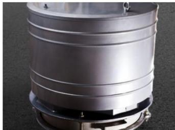
**Клапан дыхательный совмещенный КДС-1500К** – устройство, позволяющее эффективно герметизировать газовое пространство в резервуарах с летучими и горючими жидкостями. Чаще всего используются для безопасного хранения нефти и нефтепродуктов на добывающих и промышленных предприятиях. Узел комбинированный, со встроенным огнепреградителем. Выполняет роль не только клапана давления, но и эффективного вакуумного клапана. Повышает общую пожарную безопасность при интенсивной эксплуатации емкости.
