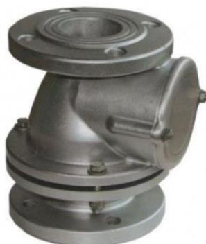
Клапан дыхательный закрытого типа КДЗТ представляет собой герметизирующий узел со встроенным огнепреградителем. Спроектирован для использования совместно с вертикальными резервуарами для хранения нефти и других огнеопасных жидкостей. Позволяет существенно сократить потери от испаряющихся нефтепродуктов, при этом обеспечивая необходимую степень защиты от взрыва или возгорания. Ресурс рассчитан на 15 лет.
